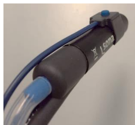
Bild 4.4 : Ansluta den monopolära kabeln med handomkopplare till höljet
