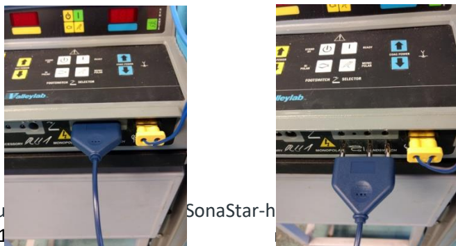
Bild 4.6 : Ansluta den monopolära kabeln med handomkopplare till höljet
