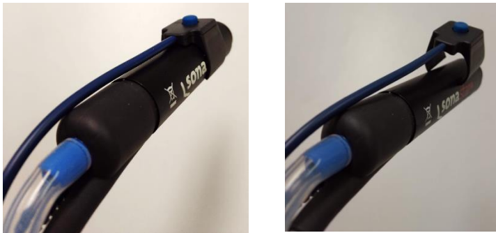
Bild 4.6 : Ansluta den monopolära kabeln med handomkopplare till höljet
