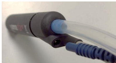
Bild 4.3: Ansluta den monopolära kabeln med handomkopplare till handstycket
