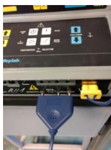
Bild 4.5 : Ansluta monopolära kabel med handomkopplare till elektrokirurgisk generator
